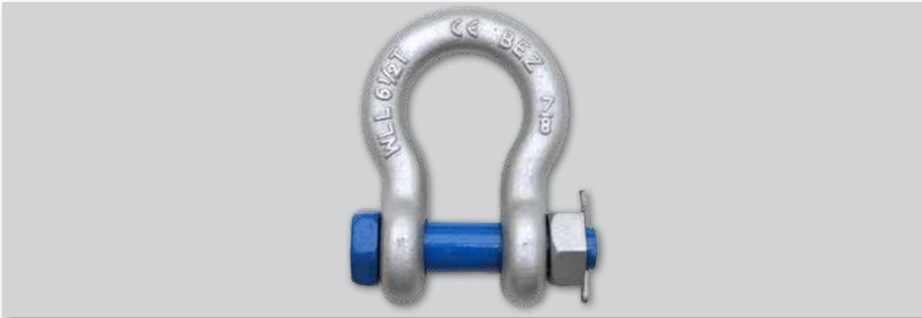
[EN] Omega type shackle made of high resistance steel, galvanized, with screwed pin, bolt and safety pin [D] Hochfester Omega-Schäkel aus verzinktem Stahl, mit Schraubbolzen, Mutter und Splint [RU] Крюк в виде буквы омега из высокопрочной оцинкованной стали, гайка и втулка [F] Manille en forme d'oméga en acier zingué à haute résistance, avec pivot fileté, écrou et goujille [I] Grillo a omega in acciaio zincato ad alta resistenza, dado e coppiglia
